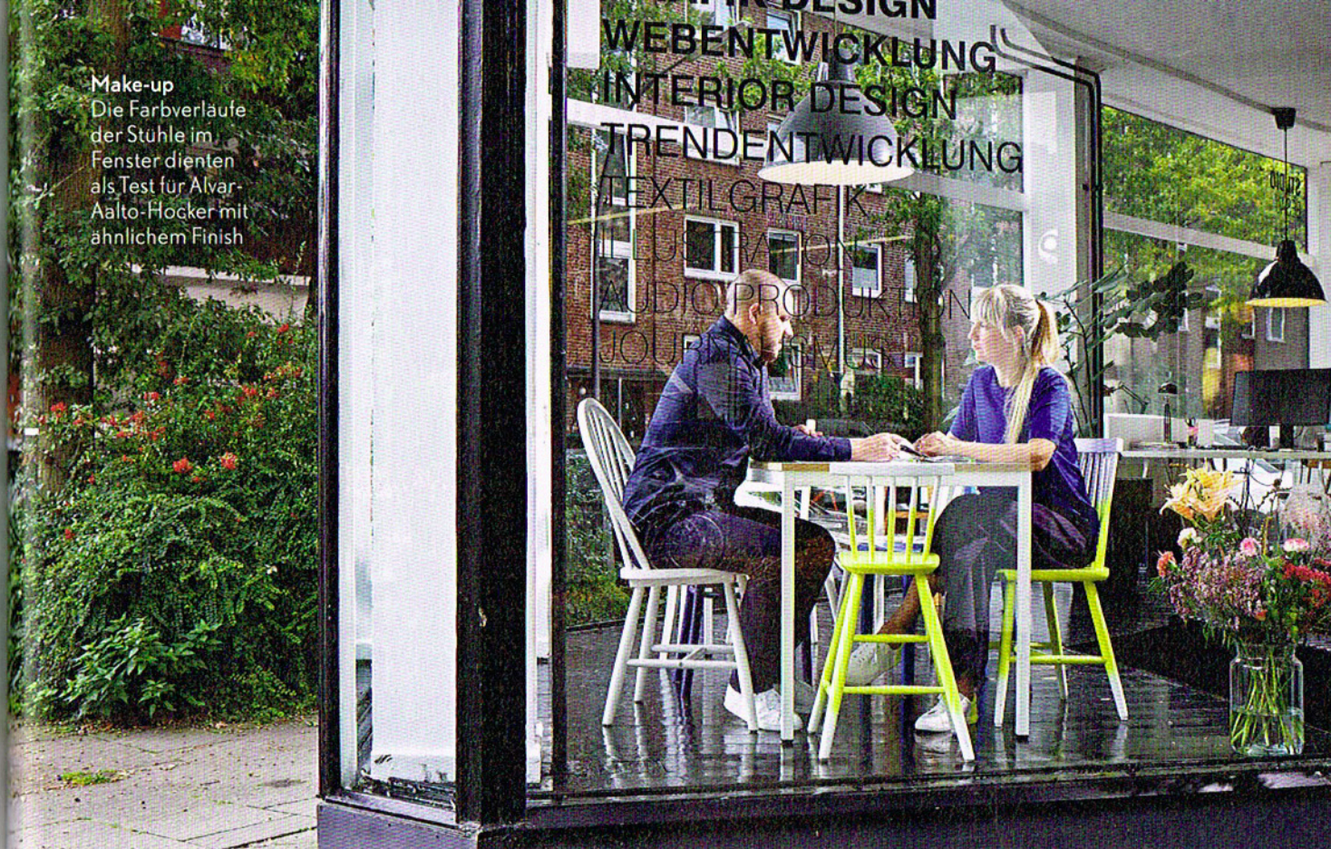
Leichtgewicht Der neongelbe Hocker „Nido“ besteht aus gewickelten Glasfasern, die in Gießharz getränkt sind. Das Möbel wiegt gerade mal 900 Gramm
