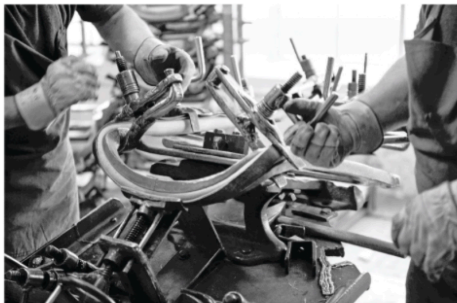
A l'usine de Frankenberg, au début des années 2010. Les pièces de bois, étuvées à plus de 100°C, épousent la forme des moules. Une innovation du XIX e siècle encore utilisée.
